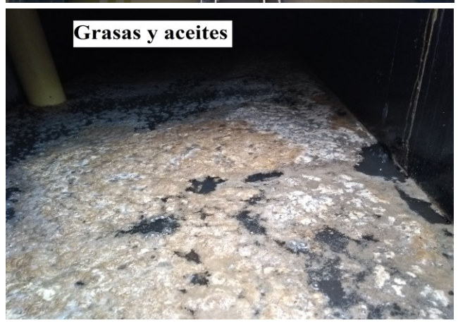
Fig 52. Sólidos flotantes extraídos del reactor UASB.
