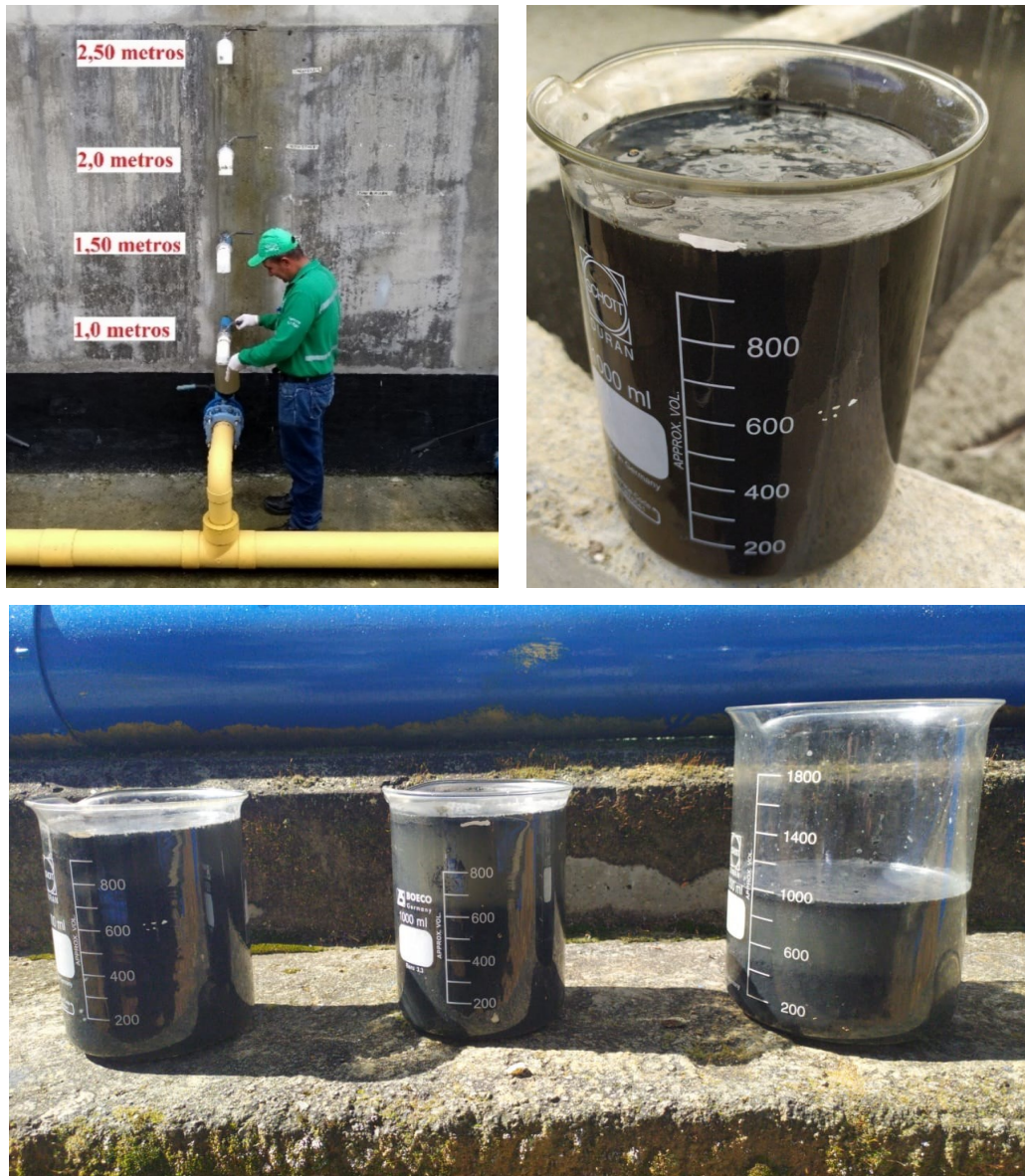
Fig 53. Lodo del reactor UASB.
