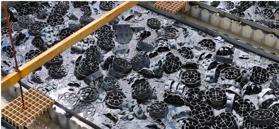
Fig 62. Material de soporte (rosetas) del reactor PBR.
