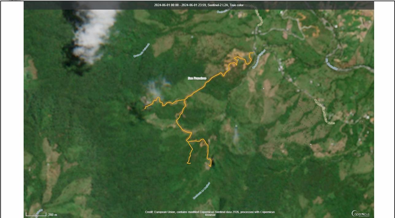
Imagen 4. Ortofoto satelital, donde se evidencia apertura de vía sobre los predios 2, 3,4,5 y 6. Imagen captada en el mes de junio del año 2024. Tomado de la plataforma Copernicus Browser
