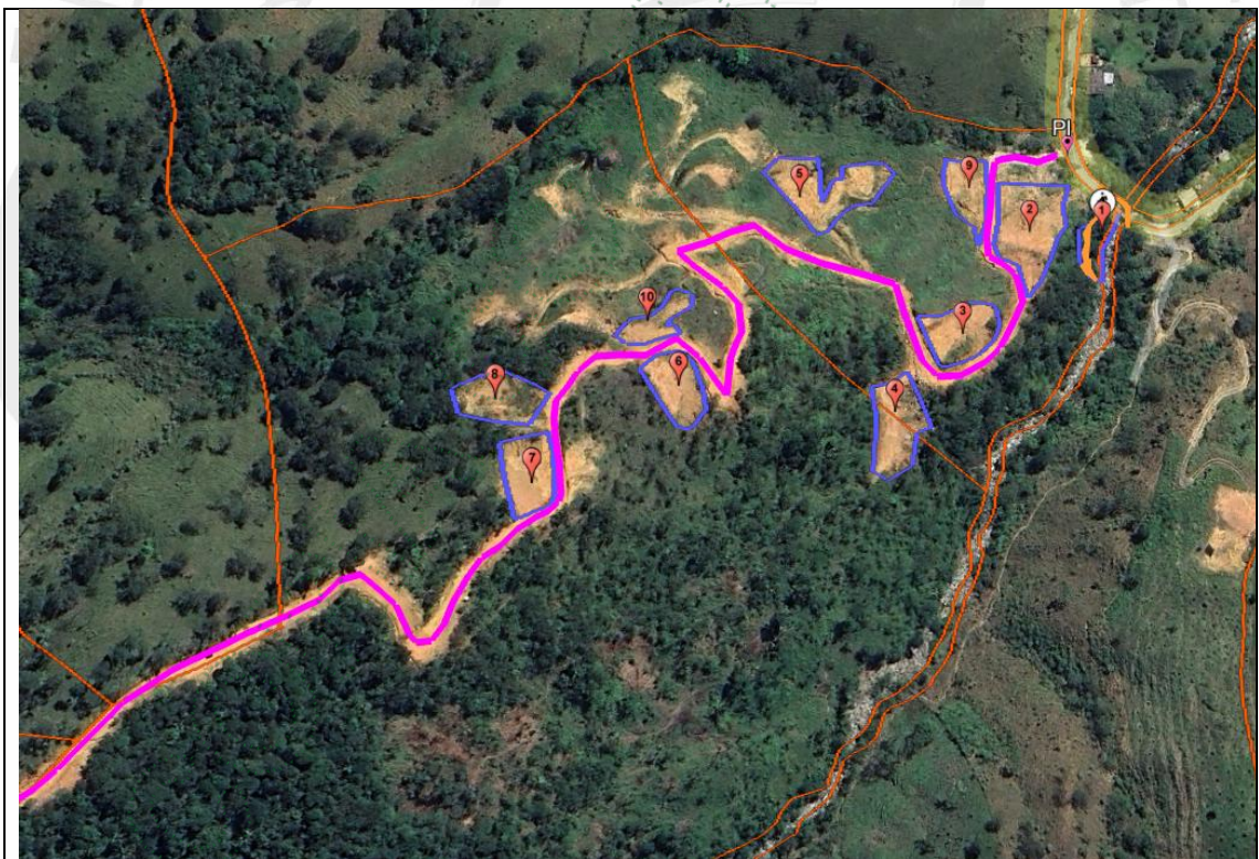
Imagen 3. Localización del predio 1, cuyo PK_PREDIO 056600001000000170075, donde se visualiza tramo de la vía 1, en color fucsia y las explanaciones realizadas Fuente: Google Earth Pro 2026.
