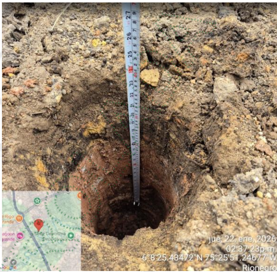
Ilustración 2 Apique exploratorio de verificación.
