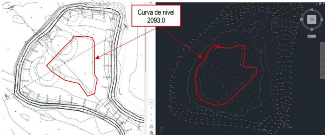
Ilustración 1 Plano de diseño y obra construida.
