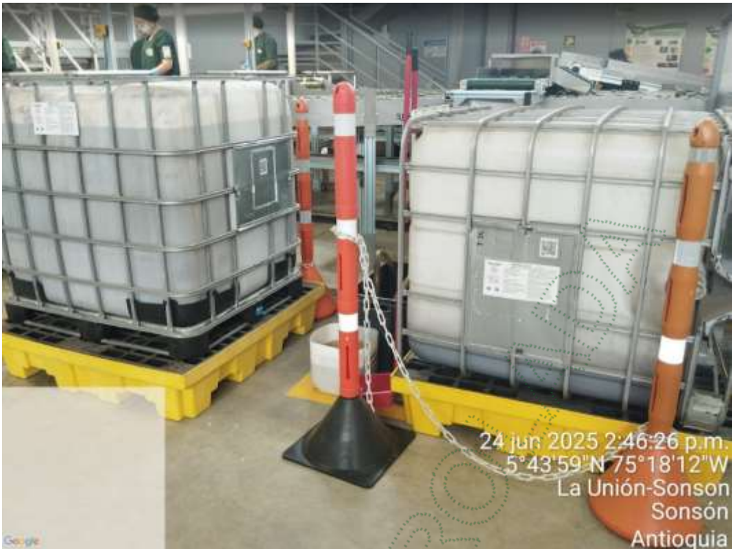
Tanques IBC para almacenamiento de fungicida utilizado en aspersión de fruta, para ser dispuesto pro ente externo
