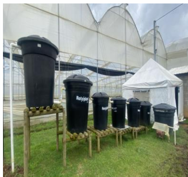
STARnD - Tanques desactivadores
