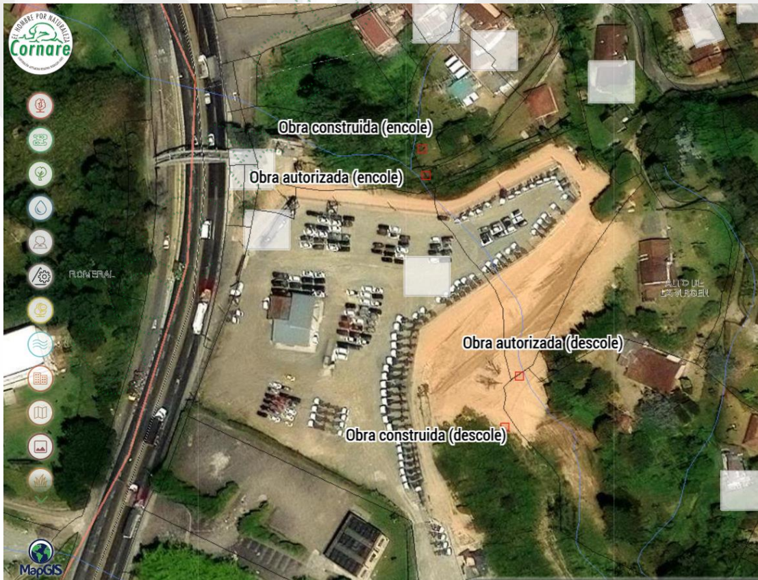
Ilustración N° 3. Coordenadas de localización de la Obra autorizada Vs. Obra construida
