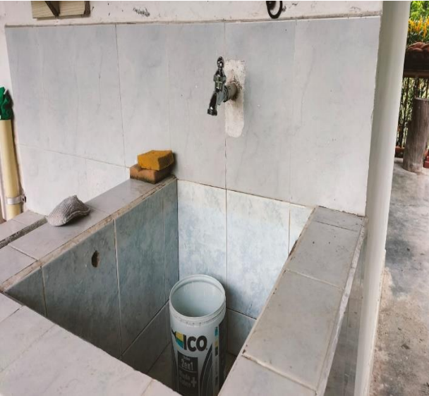
Imagen 16 y 17. Aforo en tanque y cálculo del volumen captado.
