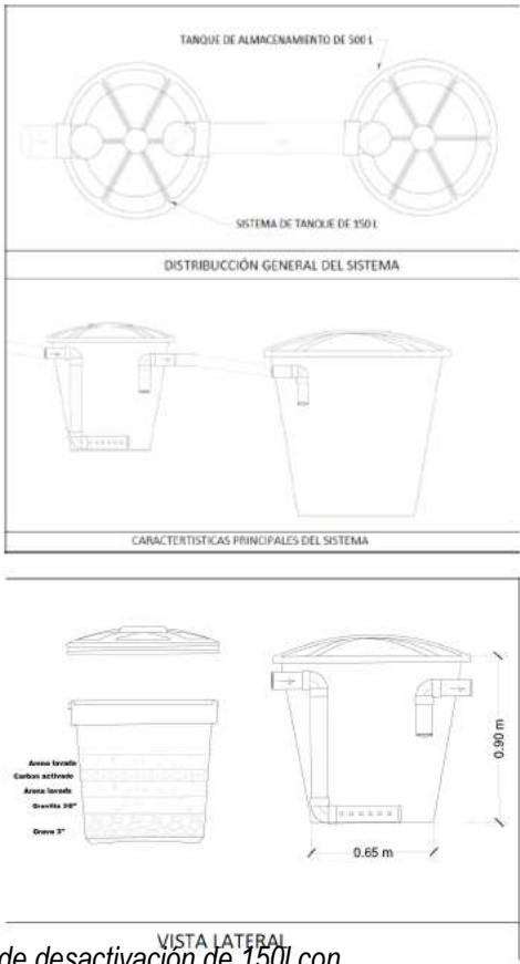
Figura 3. Diseño sistema desactivación de plaguicidas capacidad 150 litros
