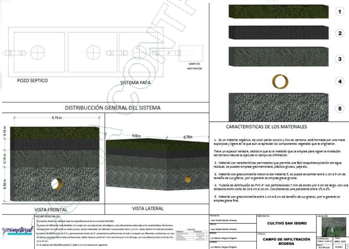
Diseño Zanja de Infiltración Bodega
