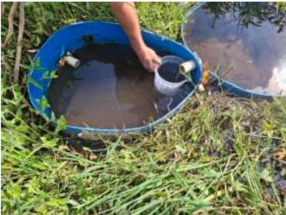
**Imagen 3.** Aforo volumetrico
