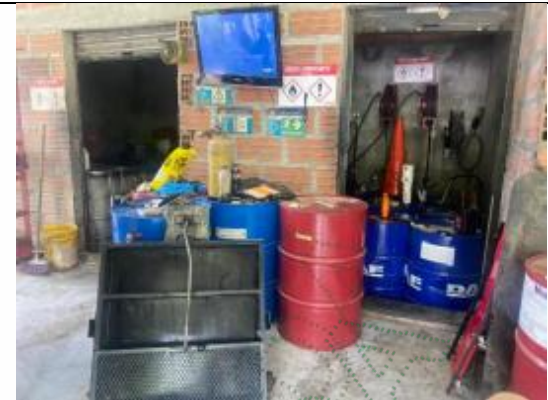
Figura 7. Centro de acopio manejo y disposición de residuos peligrosos y aceite usado, generados en el lavadero
