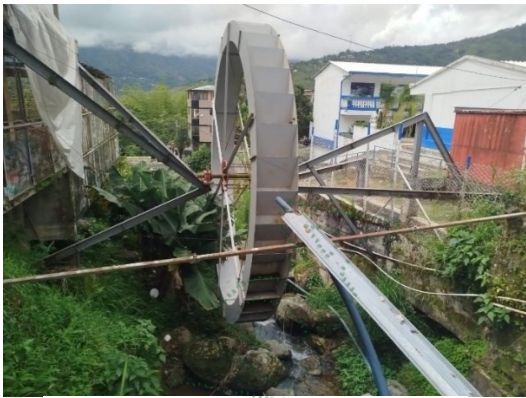
Figura 2. Rueda de Pelton localizada en el cauce de la quebrada Las Indias Fuente: Cornare, 2024.
