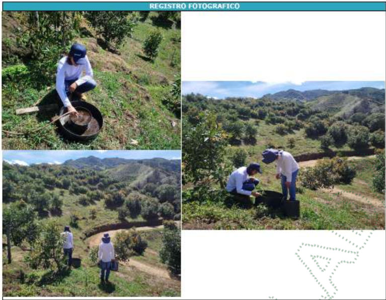
Evidencias de prueba de infiltración con doble anillo
