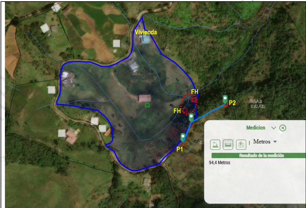
Imagen 1. Localización de Predio identificado con PK_PREDIO: 1972001000000100166 Círculo Rojo: Sedimentación de la fuente hídrica: 19.20m Línea Azul P1-P2: Actividad de movimiento de tierra: 94.34m Tomado del Geoportal Interno de Cornare MAP GIS CORNARE 2025.
