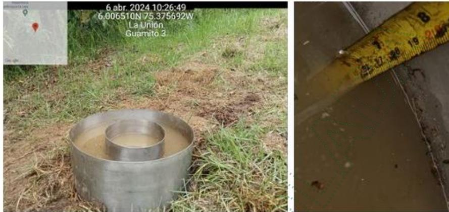
**Imagen 1.** Prueba de infiltración
