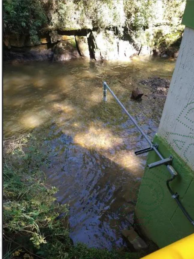
Foto 4. Detalles de la estación limnimétrica automática
