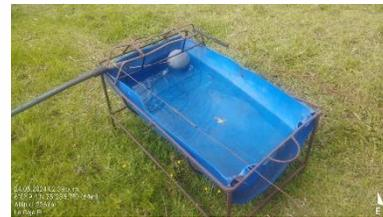
Además, se realiza un aforo volumétrico para conocer el caudal captado en la obra implementada, así mismo, se presenta el resultado del aforo:
