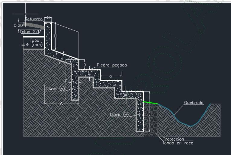
En la salida (descote) de las obras de descarga se debe de hacer una obra de disipación ya sea con piedra o dados en concreto para disipar el caudal de aporte a las fuentes, similar al ilustrado en las siguientes imágenes:
