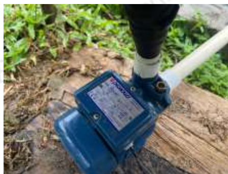
Foto 1 y 2. Motobomba usada en el proceso de recirculación de agua de los estanques piscícolas. Fuente Cornare 2024.
