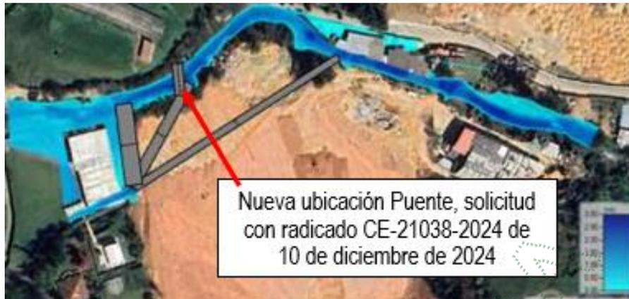
Se realiza análisis hidráulico de la obra permanente tipo puente y dos obras provisionales tipo Jarillón longitudinal, con respecto a la nueva ubicación.
