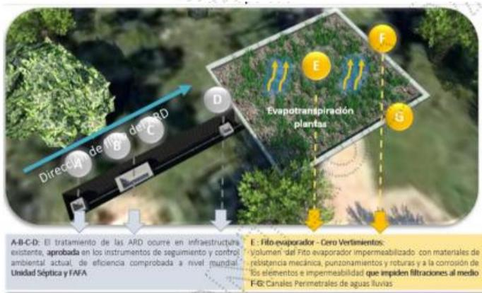
**Imagen 4.** Esquema General del STARD con Fitoevaporador información presentada por la Empresa Ecopetrol S.A.
