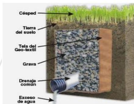
Para el cálculo del dimensionamiento de la zanja de infiltración se utilizó la metodología del documento normativo RAS 2000, Título E, donde se indican los siguientes criterios de dimensionamiento:
