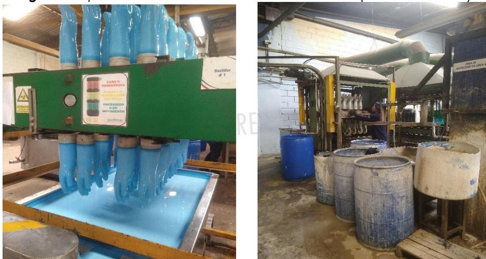
**Imagen 2.** Instalaciones para el proceso y fabricación de los guantes de látex.
