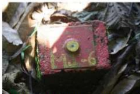
Figura 15. Obras de estabilización como geotextiles, zanja en tierra y mojones como monitoreo de los antiguos deslizamientos Q14 y Q17 en las partes altas de dichos eventos. Fuente: CORNARE (14/08/2023)
