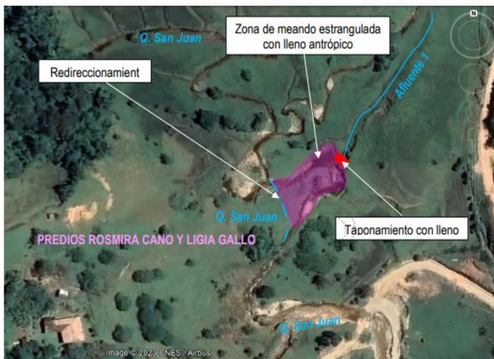
Figura 3. Intervención de desembocadura del Afluente 1. Fuente: Cornare, 2023.
