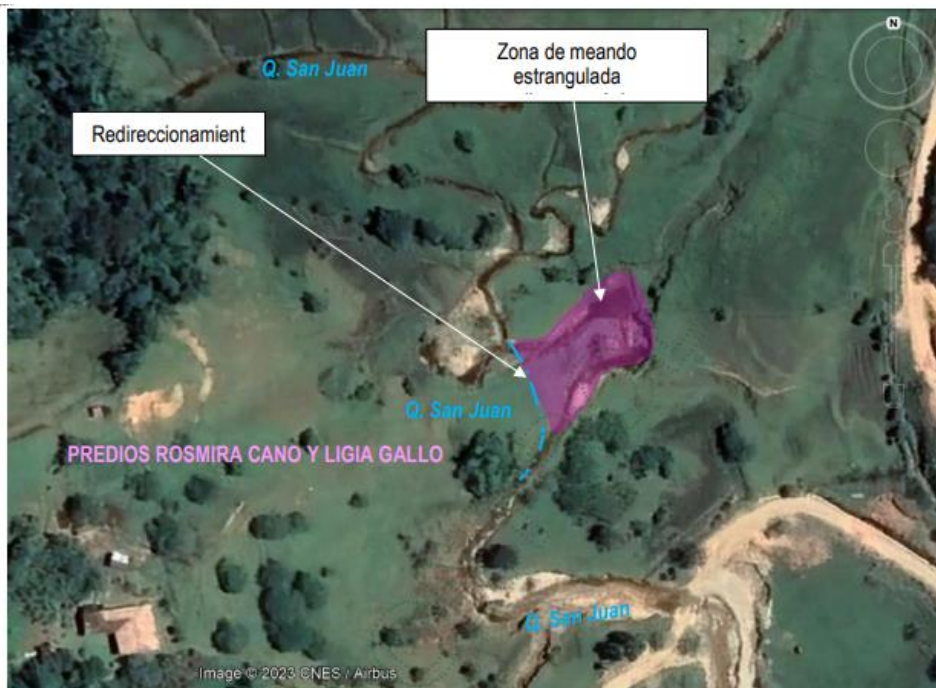
Figura 2. Estrangulamiento de meandro en la quebrada San Juan. Fuente: Cornare, 2023.
