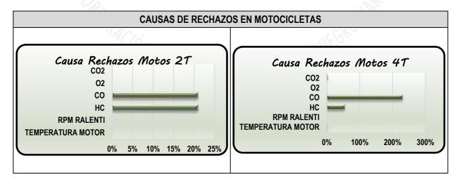
✓ En igual sentido, los resultados muestran que los rechazos a vehículos de encendido por chispa llegan al 11% del total evaluado, y de ese total rechazado el mayor porcentaje obedece a concentraciones de hidrocarburos (HC) y monóxido de carbono (CO) en los gases de escape.
