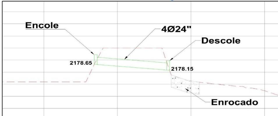
En ambos casos se propone la construcción de un enrocado al final de las tuberías para evitar la socavación del lecho en eventos de lluvia intensa. Dicho enrocado tendrá una longitud de 1.50m y una profundidad de 1.0 m.
