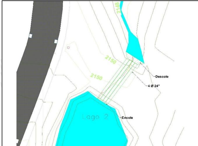
**Esquema en planta tuberías lago 3.**
