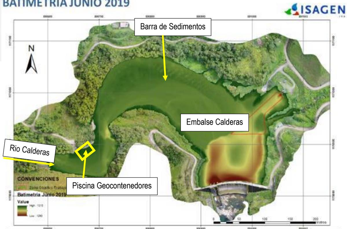
Para la modificación proponen adecuación del terreno con Geocontenedores de "Geomatrix" y conformación de piscinas de sedimentación ubicadas en el playón de la margen izquierda del embalse, con dos Piscinas # 1 (14 x 12 m) y # 2 (20 x 12 m), y la construcción de una barrera con geocontenedores que permita mitigar el impacto del agua sobre los depósitos.
