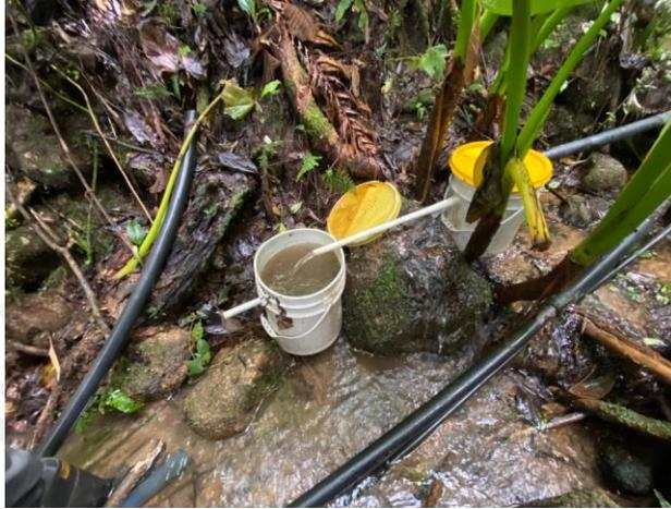
Se realizó aforo volumétrico a la entrada del agua a la segunda caneca y arrojó un caudal de **0.057L/s** caudal igual al otorgado por la Corporación, el cual corresponde a **0.057 L/s** para este usuario.
