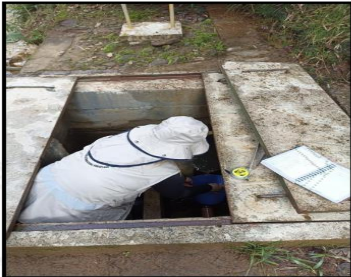
Foto 2. Aforo volumétrico en obra de control de caudal.
