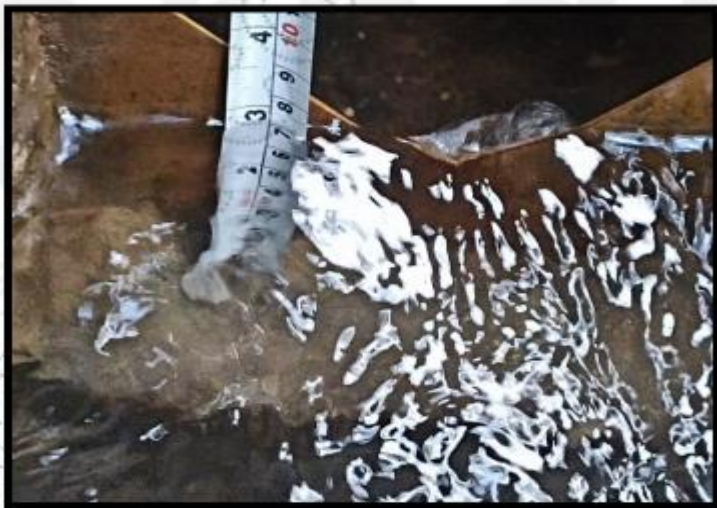
Foto 3. Medición de lámina de agua en vertedero.
