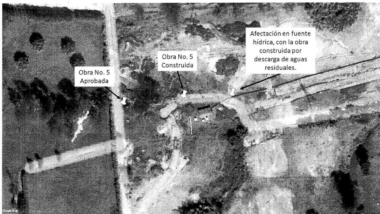
*Imagen No. 4 Modificación del sitio de construcción de la Obra No. 5*
