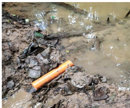
Imagen 5. Aforo volumétrico Fuente. Jhon Jaramillo Tamayo
