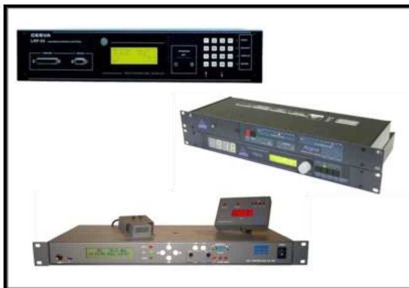
Figura 17. Ejemplos de Limitadores acústicos Arriba a la izquierda (Cesva LRF-04), En el medio derecha (MRC-Audio LD-500), Abajo a la izquierda (Apex Argos SL-Series).
