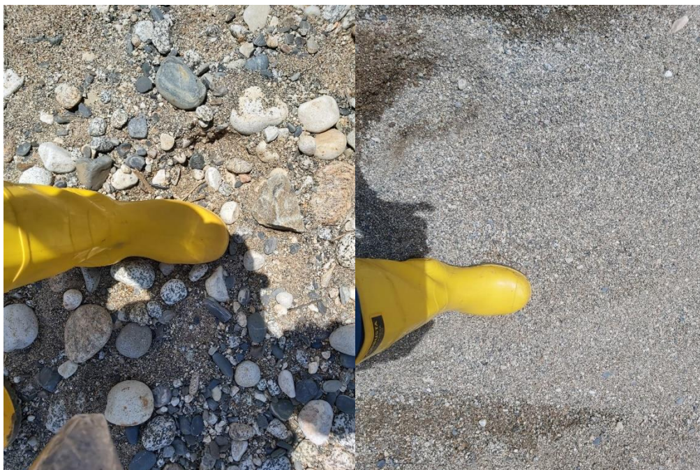
Foto 1-12. Gravas gruesas y cantos pequeños (izquierda), gravas finas y arenas gruesas (derecha) depósito de sedimento en curva interna aguas arriba de la PCH El Popal
