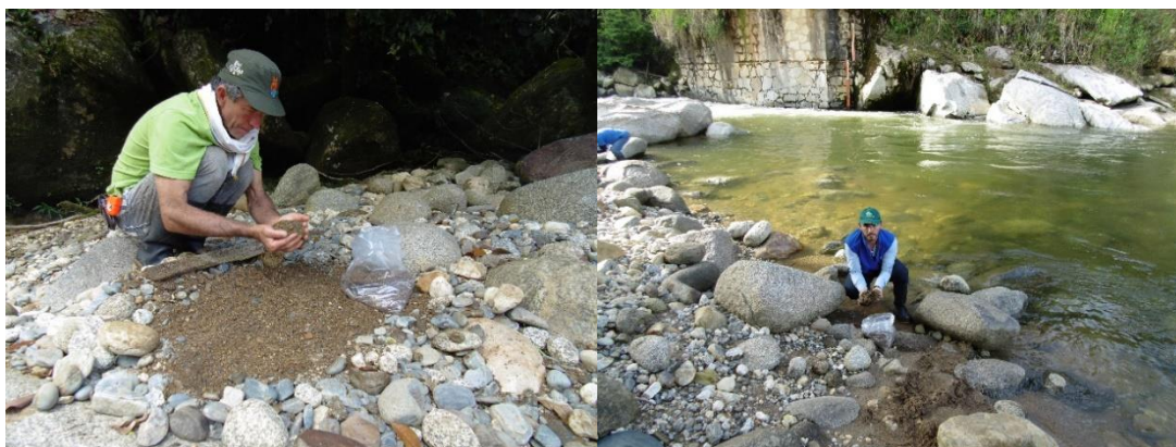
Foto 1-4. Toma de muestra de material superficial y subsuperficial para análisis granulométrico
