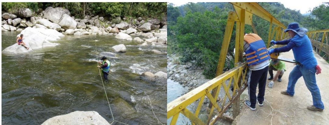
Foto 1-2. Aforo líquido realizado por método de vadeo y suspensión
