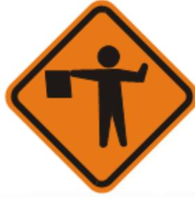
SPO-03: Esta señal se empleará para advertir a los conductores la aproximación a un tramo de vía que estará regulado por personal de la obra, el cual utilizará señales manuales.
