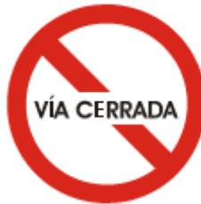
SRO 01: Esta señal se empleará para notificar a los conductores el inicio de un tramo de vía por el cual no se permite circular mientras duren las obras.
