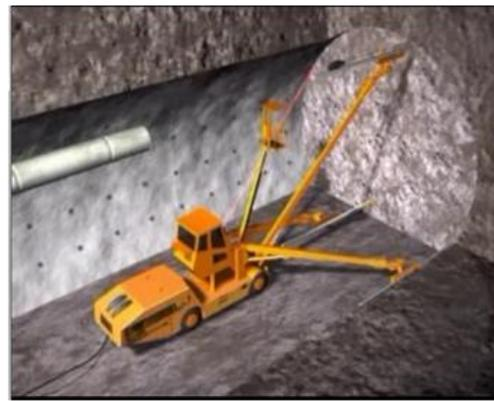
Equipo jumbo para perforaciones de avance de excavación.
